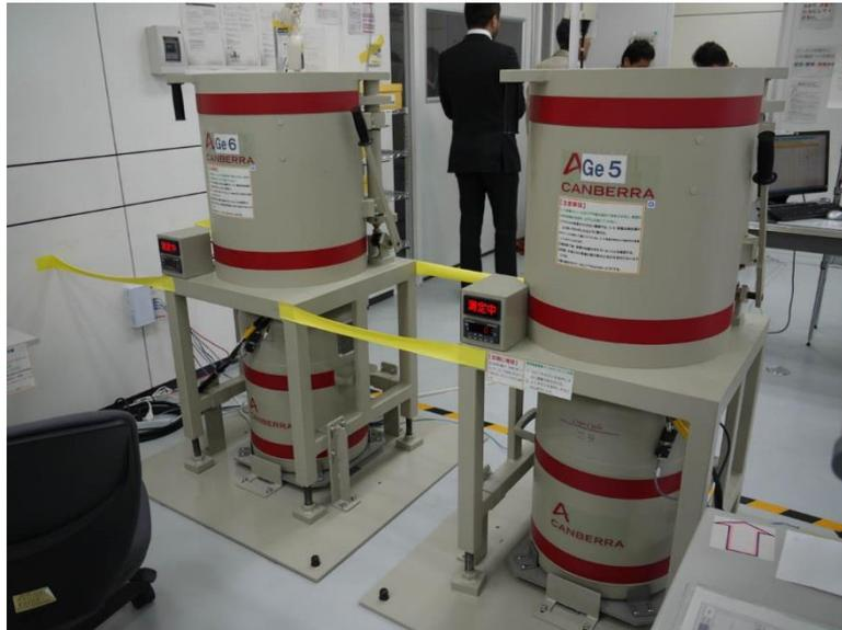
写真3. 福島県農業総合センターでは定期的にゲルマニウム測定器による検査が行われている
