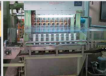
安全に使えるよう通常よりも作動速度を遅く改良した洗ビン機
